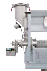
Generator wibracyjny przy leju napełniającym zapewnia lepsze podawanie proszku
