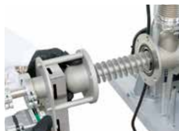
Ślimak przenośnika z regulowaną prędkością obrotową
